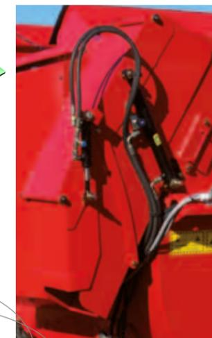
Les casquettes peuvent être commandées hydrauliquement (option) et permettre du tracteur d'orienter le jet sortant au pied de la machine. Cette fonction est idéale pour pailler derrière les cornadis.
