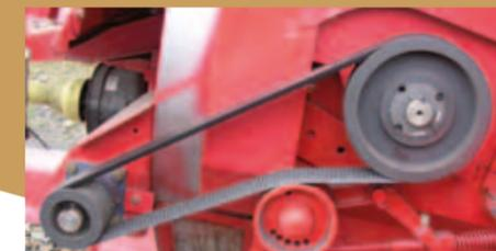
Un entraînement du démêleur bas par courroie est disponible (en option) sur les modèles entraînement mécanique.
