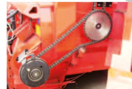
Une version avec embrayage électromagnétique permettant de bloquer l'entraînement des démêleurs le temps que la turbine se lance est disponible en option.
