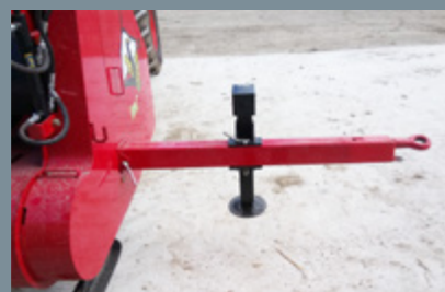
Flèche pour chariot embarqué pénètre intégralement dans le châssis du Pick-up
