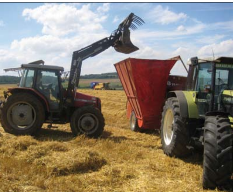
Installé au niveau du pick-up de la presse, l'entonnoir oblige à charger la menue-paille avec un tracteur ou un chariot télescopique. Cependant, l'inventeur réfléchit à un système d'alimentation autonome.
