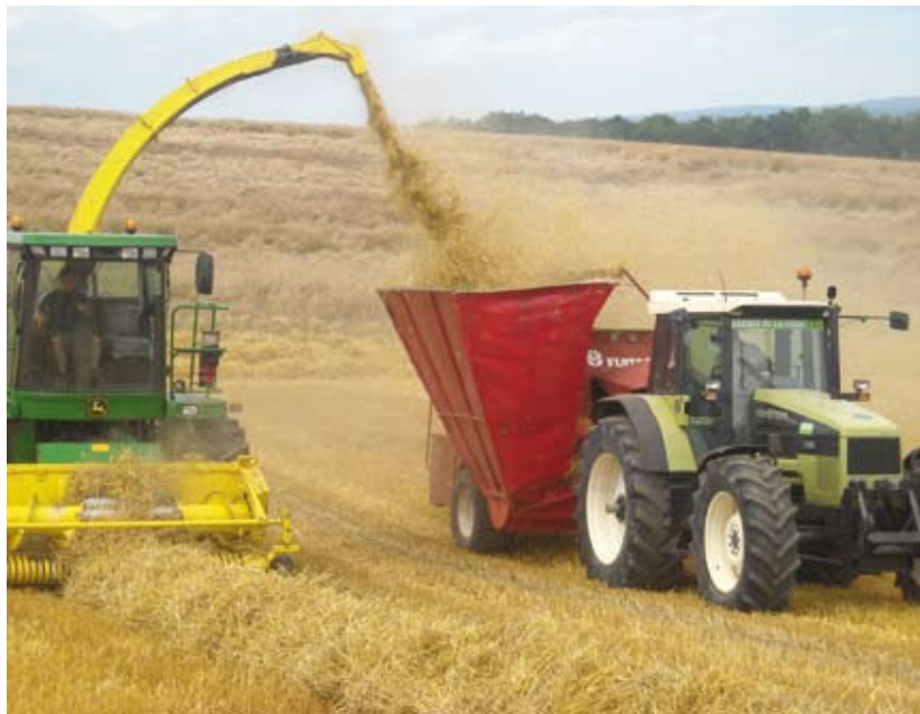
L'Entonn'Up ouvre de nouvelles solutions de récolte, tels que le pressage au champ de paille reprise à l'ensileuse.
